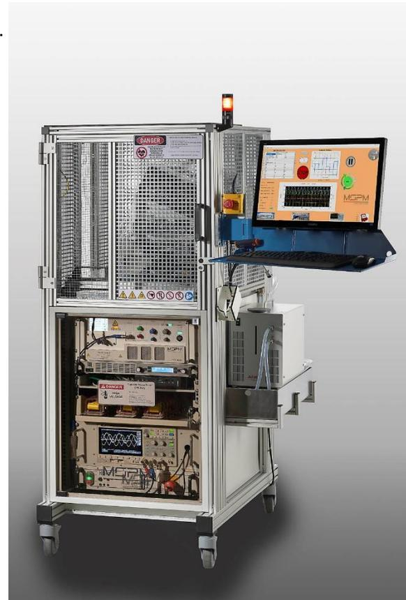
CPT2022 Teststation für Leistungskondensatoren
